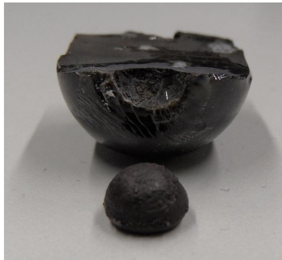
Abb.45: Abtrennung der Metalle durch Umschmelzen der Schlacke [3].
