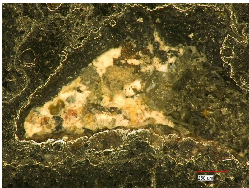
Abb.23: Makroskopische Aufnahme von mineralischen Partikeln umschlossen von einer Magnetitschicht [3].
