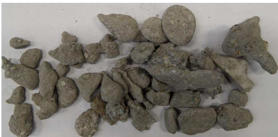
Abb.55: Metallpartikel aus der im Verlauf der konventionellen Schlackenaufbereitung über eine Wirbelstromtrennung abgeschiedenen NE-Metallfraktion.
