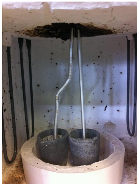
Abb.29: Experimenteller Aufbau zur Überprüfung der ersten Hypothese zur Bildung der Magnetitschalen [41].
