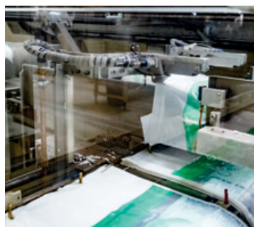
Am Ende der Anlage werden die Produkte gepresst und in Folienbeutel verpackt, die am Boden verschweißt werden.
