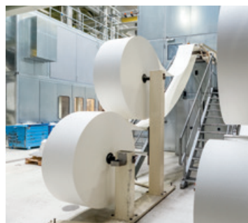
Die Rollen laufen anschließend in die Anlagen ein, in denen eine Mühle aus der gepressten Zellulose lockere Flocken macht.
