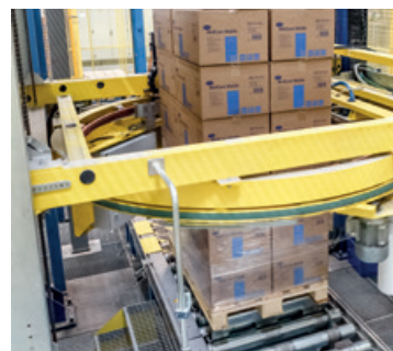
Verpackt in Kartons und auf Paletten gestapelt werden die Produkte dann in Folie eingeschweißt und ins Lager transportiert.
