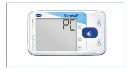
En la pantalla de su tensiómetro aparece «PC». Dispone de 30 segundos para transferir los datos, de lo contrario el dispositivo pasará al modo stand-by.
